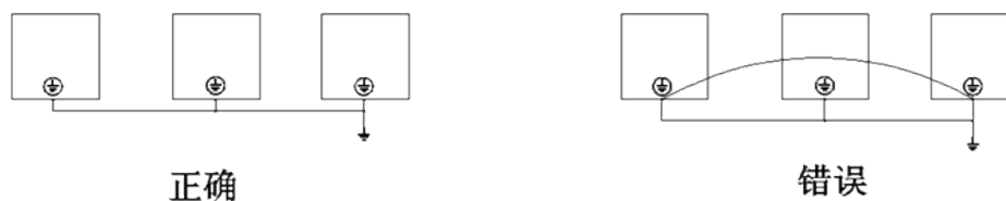
图 3-4 接地线接法示意图
