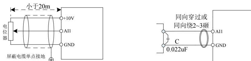
图 3-8 模拟量输入端子接线方式
